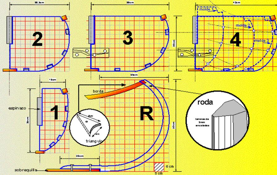
VISTA del armado provisorio con el espinazo, rodas, bordas y sobrequilla
